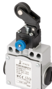
Łączniki PDM1 – głowica R38 popychacz stalowy i dźwignia z rolką z tworzywa Ø22 z resetowaniem
